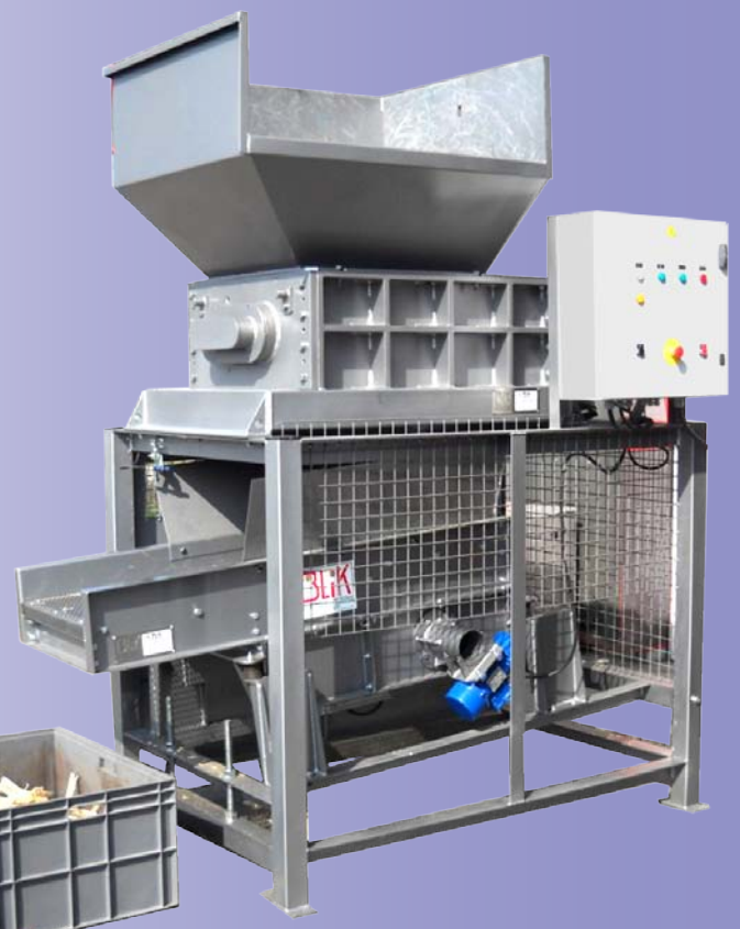
Ci-dessous table vibrante BLIK en sortie d'un broyeur BLIK B600
