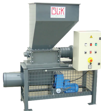
BB230 sortie vis «BLIK» un sac à déchets quelconque s'adapte facilement à la sortie de la vis
