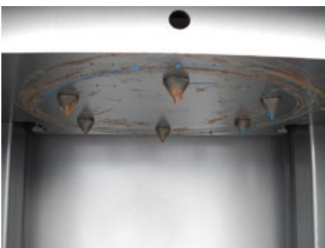
poinçons pour le maintien du fût et le vidage de l'air punches for the maintenance of the barrel and the emptying of the air
