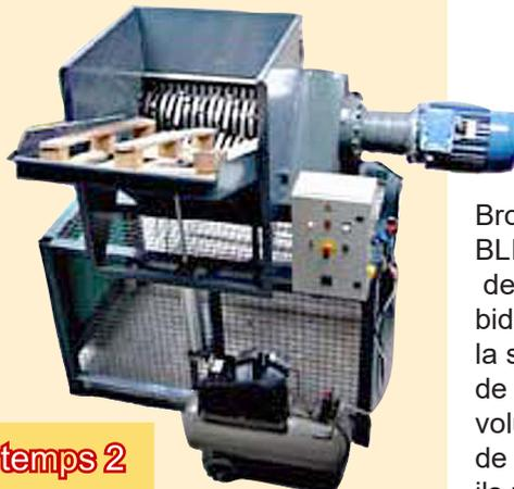
Broyeur BLiK B600 avec table d'alimentation pneumatique
