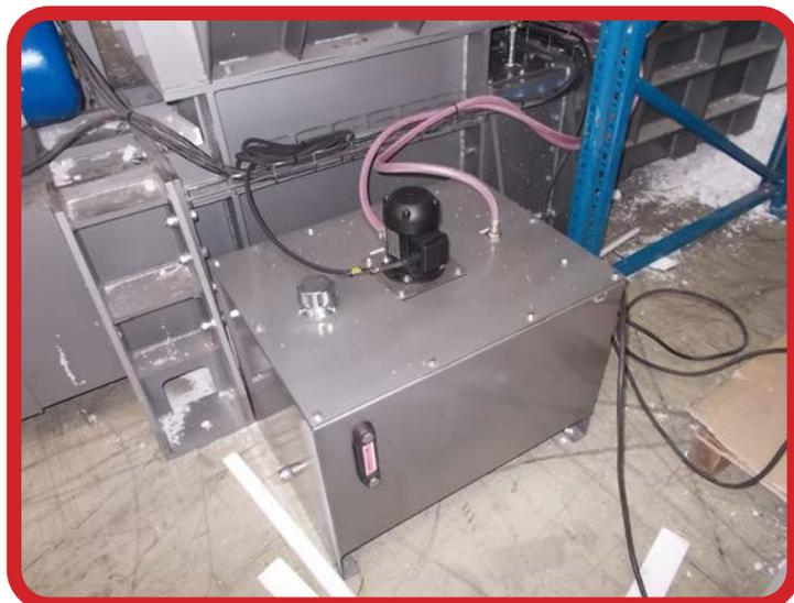
Une fois déchiqueté, le polystyrène est chauffé et compacté par une vis. Cependant, il est important que le canal de compaction ne dépasse pas une certaine température, sans quoi le polystyrène fond et bloque la machine. Nous avons donc inclus un système de refroidissement par circulation liquide ainsi qu'un réservoir de 80 litres. Cela permet à la POLY-4000 de fonctionner sans interruption toute la journée et d'obtenir un résultat constant.
