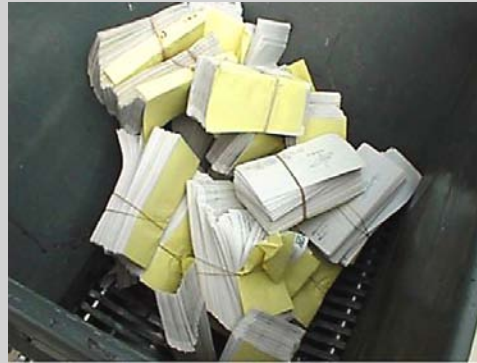
Shredding and destroying cheques. rendement 360 kg /heure couteaux 8mm niveau de sécurité DIN 2
